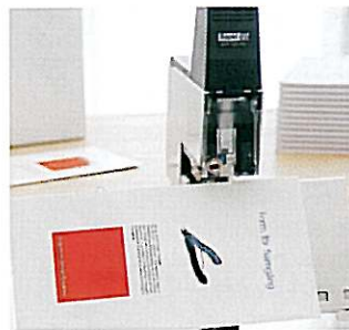
Rygfalshæftning med R106E. Indstilleligt papirstop giver nøjagtig klammeplacering. Hæftning altid med pedal.
